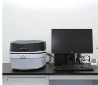
能量色散型X线荧光分析装置(EDX)
